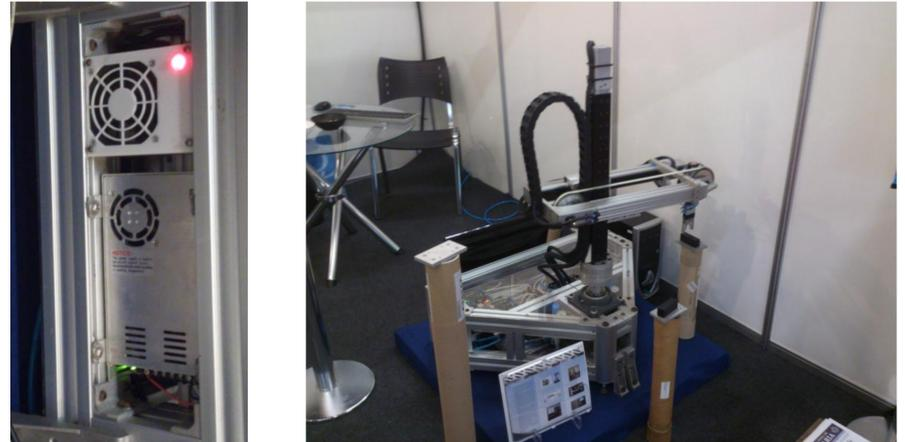
Figura 3 – Fontes instaladas, e visão do manipulador em funcionamento.
