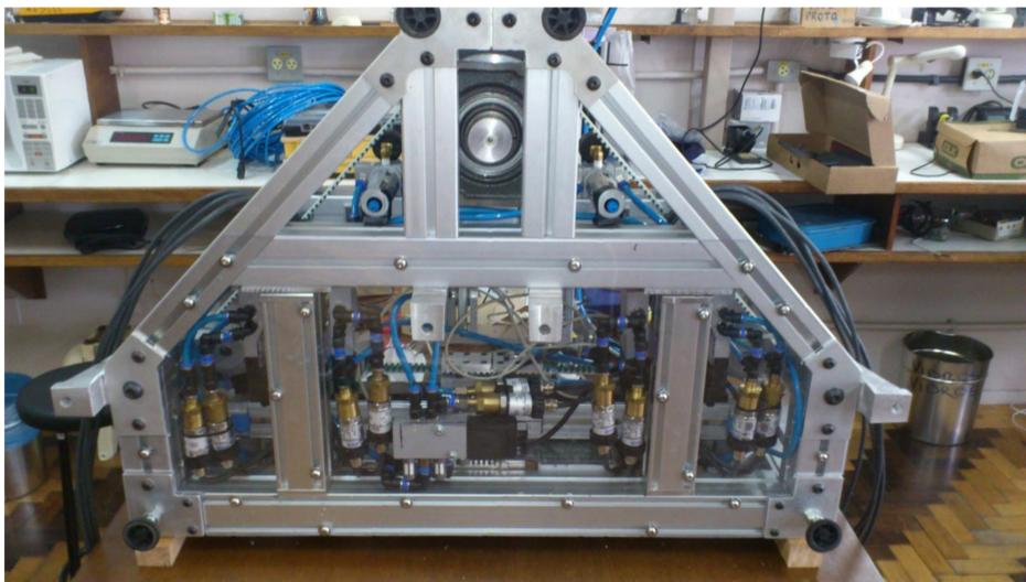
Figura 1 – Vista inferior (válvulas de controle e sensores de pressão)
