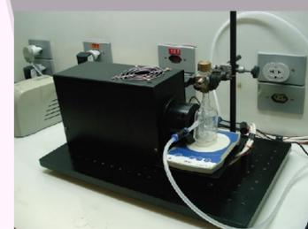
A *Water Splitting* ocorre quando essa solução é irradiada com luz UV. O Ta<sub>2</sub>O<sub>5</sub> absorve fótons com energia igual ou superior ao seu nível de energia do *band gap*. Assim, elétrons são excitados na banda de valência e promovidos para a banda de condução. As lacunas foto geradas na banda de valência oxidam as moléculas de água em 2H<sup>+</sup> e ½ O<sub>2</sub> e, simultaneamente, os elétrons foto gerados na banda de condução reduzem 2H<sup>+</sup> em H<sub>2</sub>.
