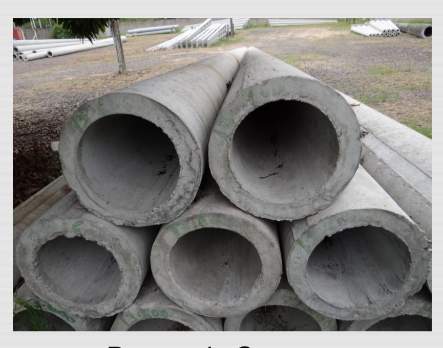
Postes de Concreto
