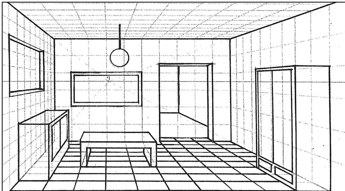
**Figura 13** – Exemplo de representação em perspectiva cônica.
