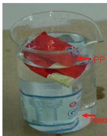
Figura 2. Separação de PP e PEBD por densidade.
