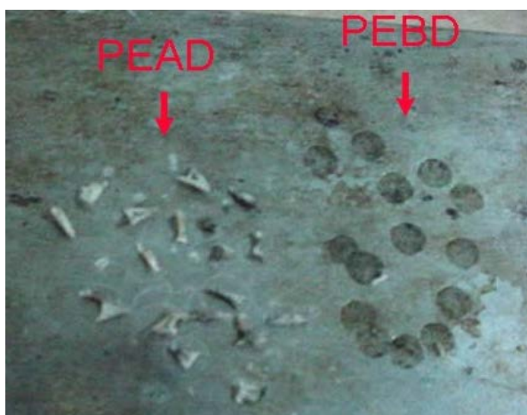
Figura 3. Formas de solidificação do PEAD e PEBD após queima.
