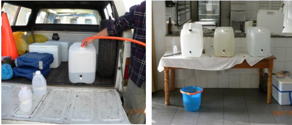
Figura 19. Procedimento de coleta de amostra e separação do precipitado de \text{BaCO}_3 para envio ao laboratório.
