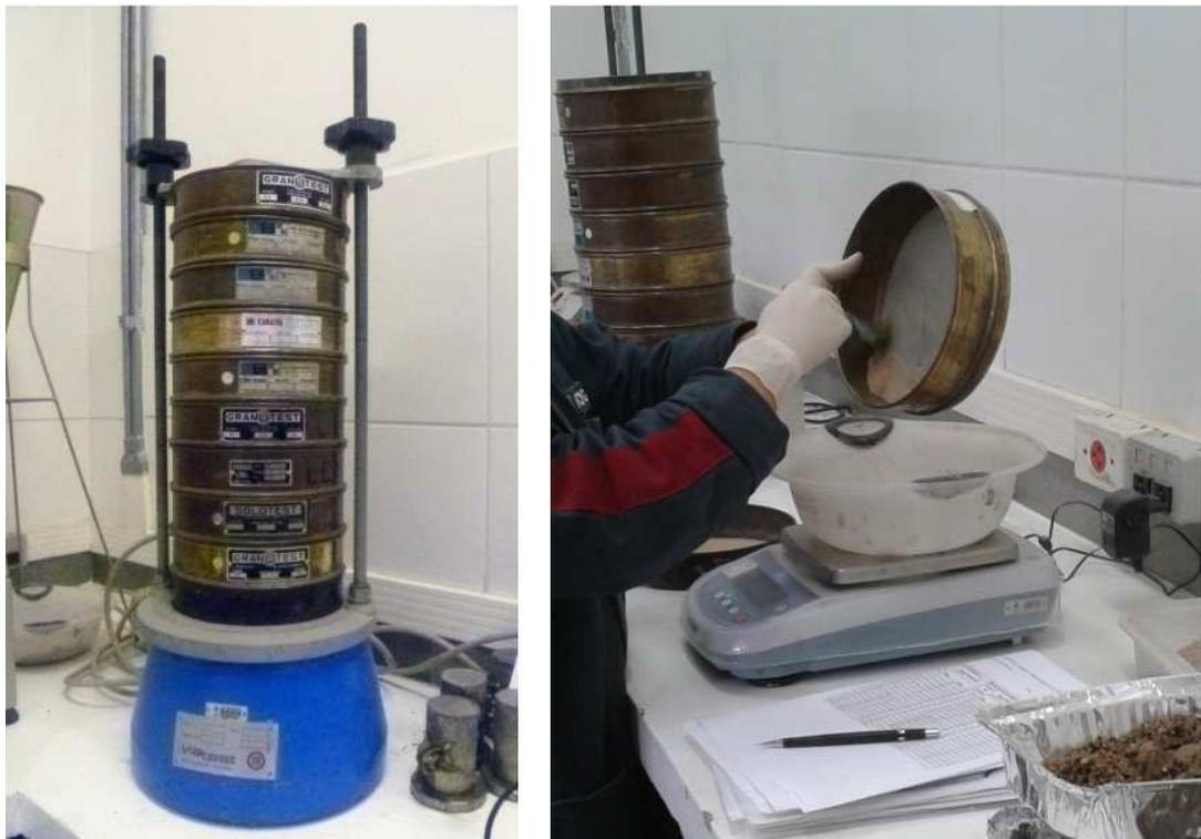
Figura 26: Equipamentos utilizados para determinação granulométrica
