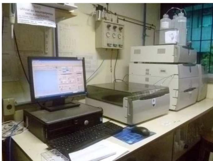
Figura 29: Cromatógrafo iônico utilizado no laboratório
