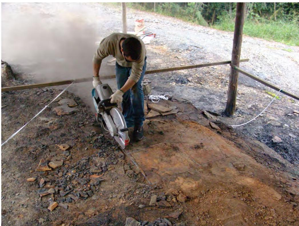
**Figura 4. Detalhe de como as amostras de folhelho são extraídas com serra em campo.**
