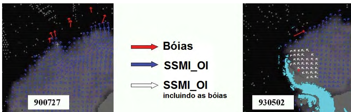
Figura 28 – Comparação entre os vetores de movimento do gelo marinho obtidos pelas boias de deriva e estimados pelo satélite SSM/I. Na esquerda nota-se discrepância devida ao rápido crescimento da borda de gelo no sentido norte no ano de 1990 e ao fato das boias terem ficado próximas a borda de gelo. Na direita, nota-se uma concordância muito boa entre os vetores, em especial, próximo a península Antártica. Fonte: SCHMITT & DRINKWATER (2004).
