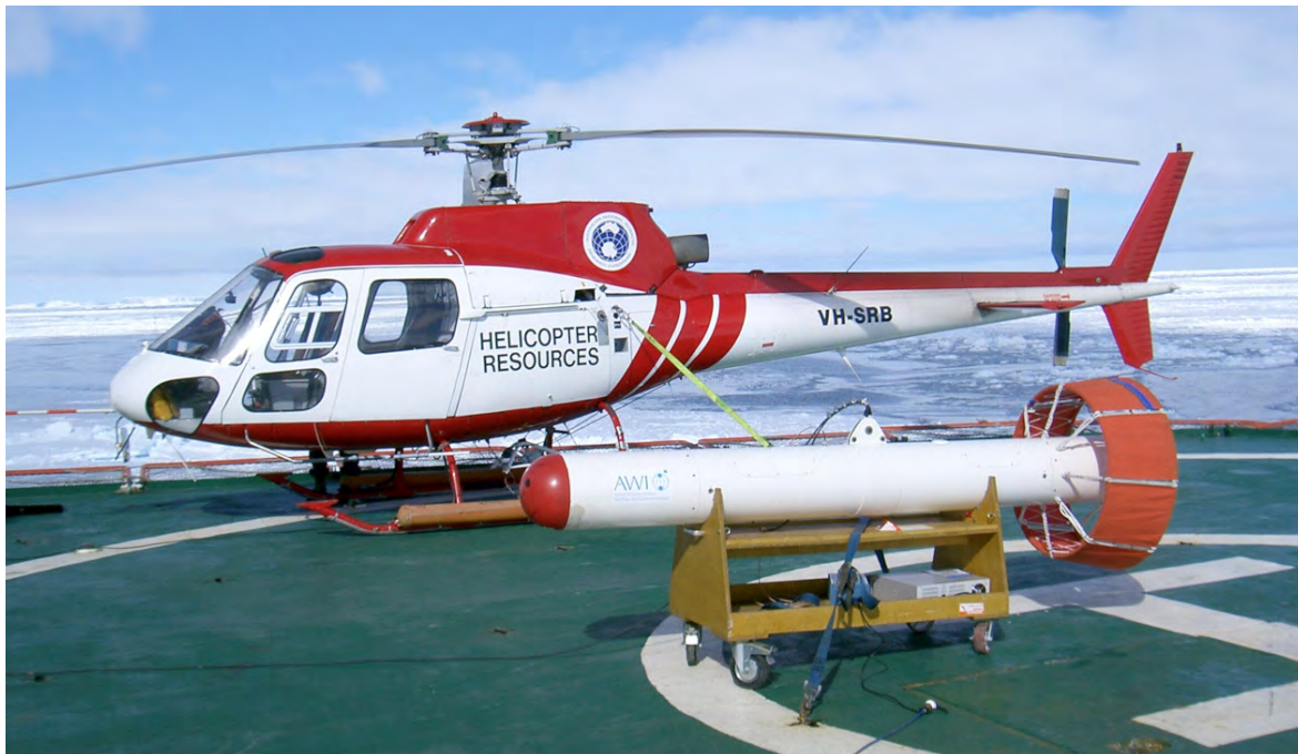
Figura 44 - Sistema de indução eletromagnética HEM (Helicopter EleTroMagnetic system) do AWI ao lado do helicóptero a bordo do RSV "Aurora Australis". Fonte: PFAFFLING, HAAS & REID (2004).
