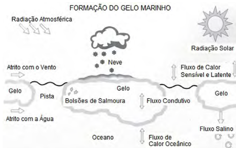
Figura 8 – Processos de formação do gelo marinho: pela ação de fortes ventos, a água superficial atinge a temperatura de congelamento, começa a formar cristais de gelo que se aglutinam e vão espessando cada vez mais o bloco de gelo. A neve que precipita sobre o gelo, ocasionalmente contribui para o seu espessamento, seja por sofrer compactação, for encharcar e recongelar, ou por atuar como isolante térmico. Adaptado de PETIT & NORRO (2000).
