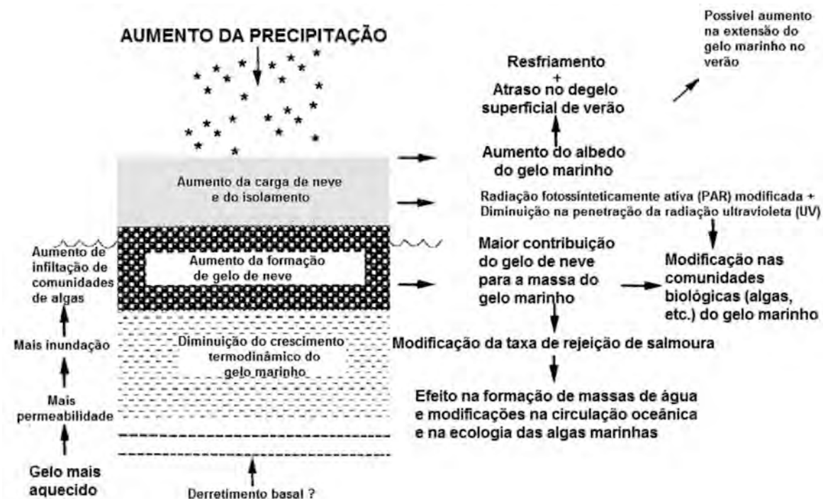
Figura 37 – Esquema do efeito do aumento de precipitação de neve sobre o gelo marinho no oceano Austral, em função do aquecimento global, no sistema neve–gelo–oceano–atmosfera. Adaptado de MASSOM et al. (2001).
