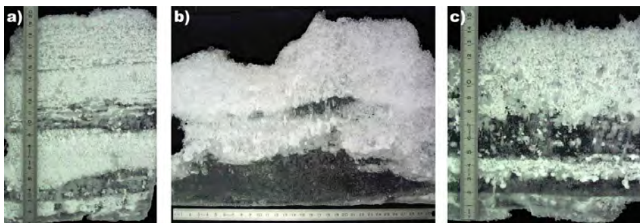
Figura 15 – Seções verticais superficiais mostrando neve metamorfozada. (a) e (c) sobre gelo de segundo ano, e (b) sobre gelo de primeiro ano. Fonte: NICOLAUS, HAAS & WILLMES (2009).
