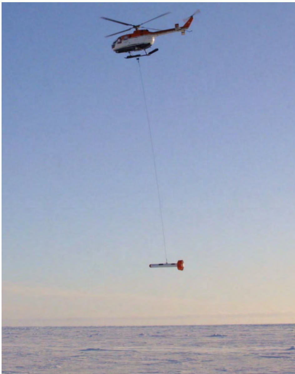
Figura 48 - O helicóptero realizando um perfil com o sistema eletromagnético. Fonte: PFAFFLING (2003).
