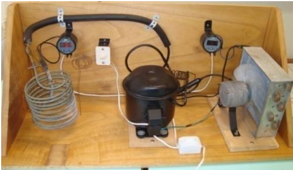
Figura 21: Representação do ciclo de refrigeração.
