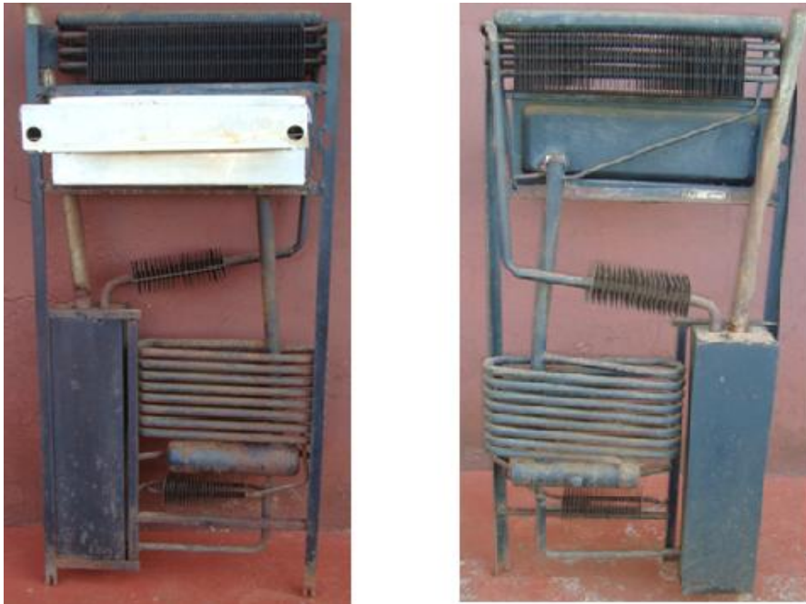
Figura 03: Sistema de refrigeração por absorção de geladeira a querosene da empresa Consul da década de 1960.
