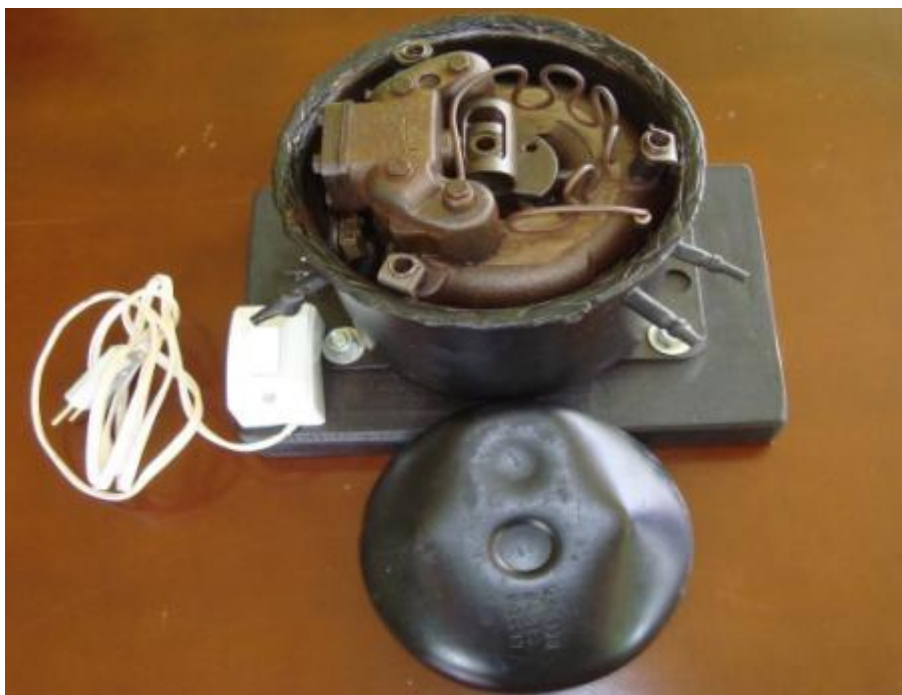
Figura 01: compressor hermético aberto e montado sobre suporte de madeira e preparado para aula expositiva.
