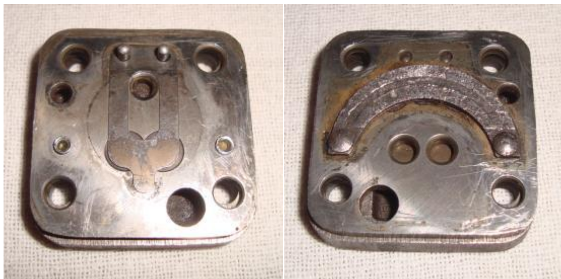
Figura 12: Válvulas de sucção e descarga.
