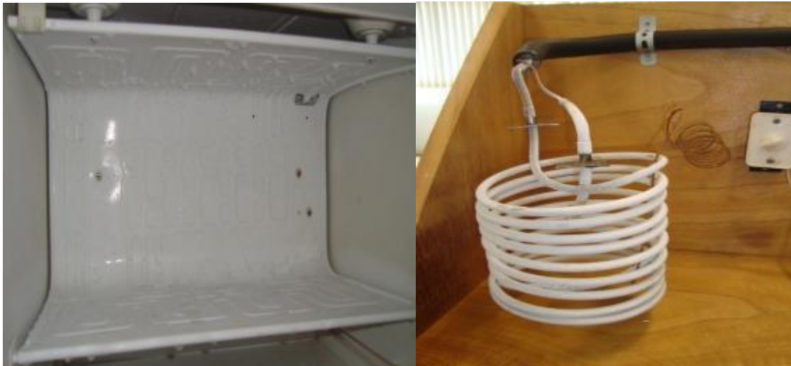
Figura 22: Evaporador de geladeira doméstica – evaporador.
