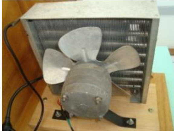
Figura 16: Condensador de convecção forçada.
