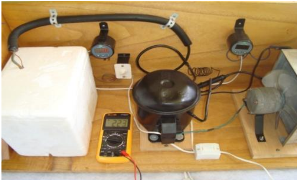
Figura 26: Leitura da tensão de funcionamento da bancada didática e simulação da eficiência energética.
