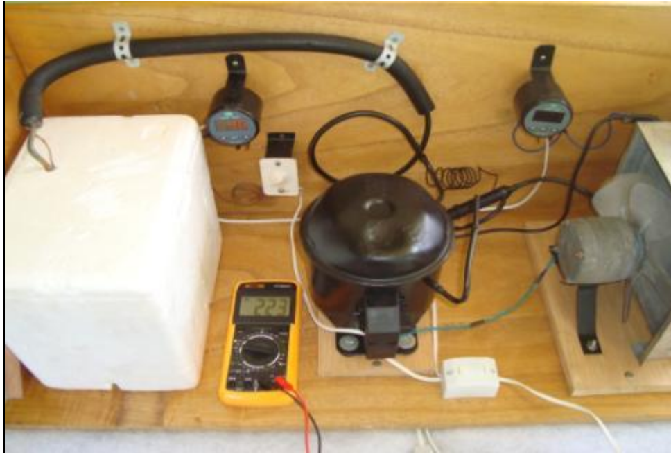
Figura 07: Imagem da bancada didática durante a leitura da tensão para simulação da eficiência energética.
