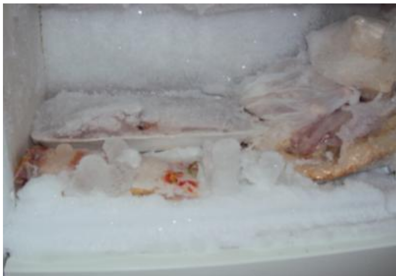
Figura 23: Congelador de geladeira com excesso de gelo.
