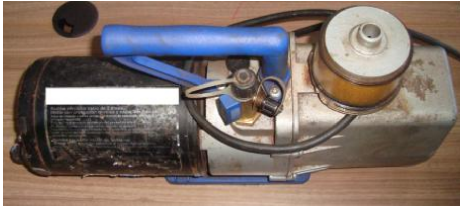
Figura 19: Bomba de vácuo utilizada para retirar o ar atmosférico e a umidade do sistema de refrigeração durante a manutenção.
