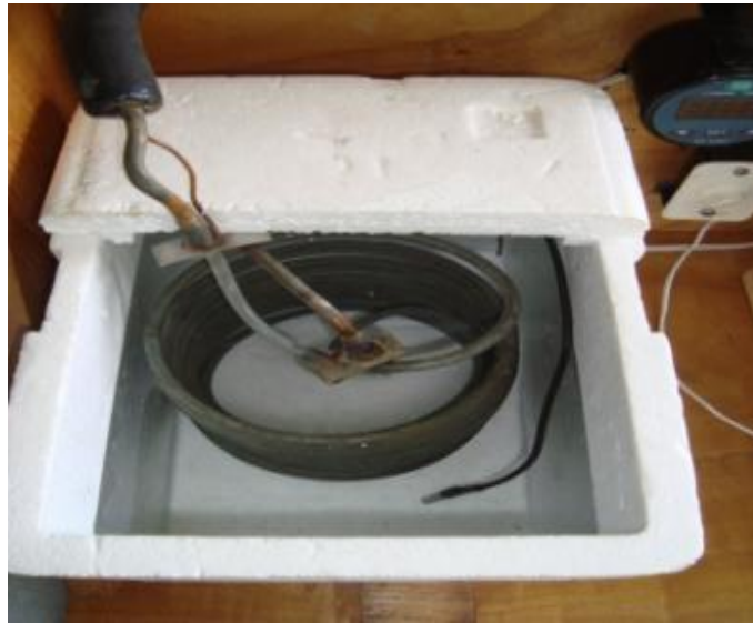
Figura 25: Reservatório de isopor contendo o evaporador imerso em água e o sensor de temperatura.
