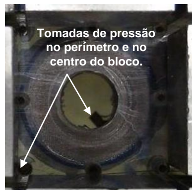
Figura 4.9 – posicionamento das tomadas no fundo das juntas, em torno do bloco central
