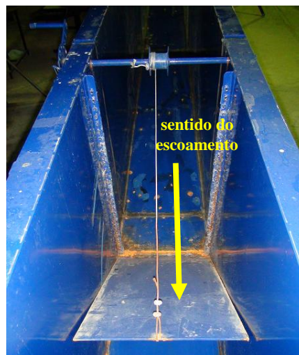
Figura 4.5 – comporta de jusante
