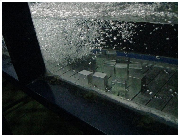
Figura A.14 – arrancamento dos blocos posicionados no local de impacto do jato (quando não colados, em ensaio preliminar)
