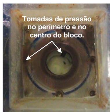
Figura 4.10 – posicionamento das tomadas no fundo da cavidade, em torno do bloco
