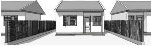
Térrea com as laterais descoladas do limite do terreno.
