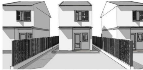
Sobrado com as laterais descoladas do limite do terreno.
