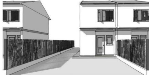
Sobrado com uma das laterais coladas no limite do terreno.
