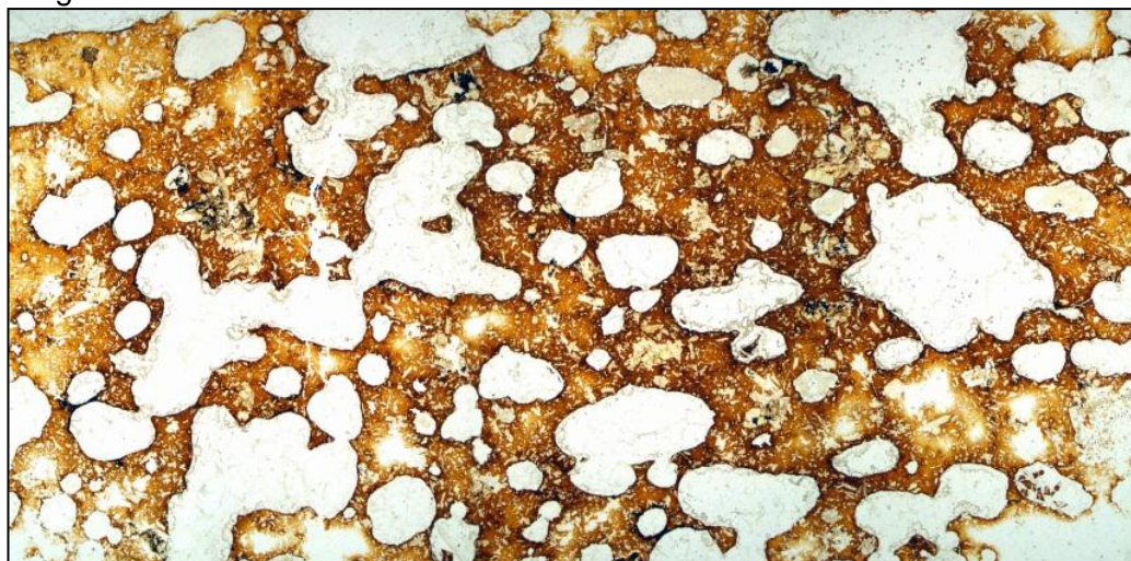
Figura 24. Foto da lâmina em sua totalidade com coalescência de cavidades
