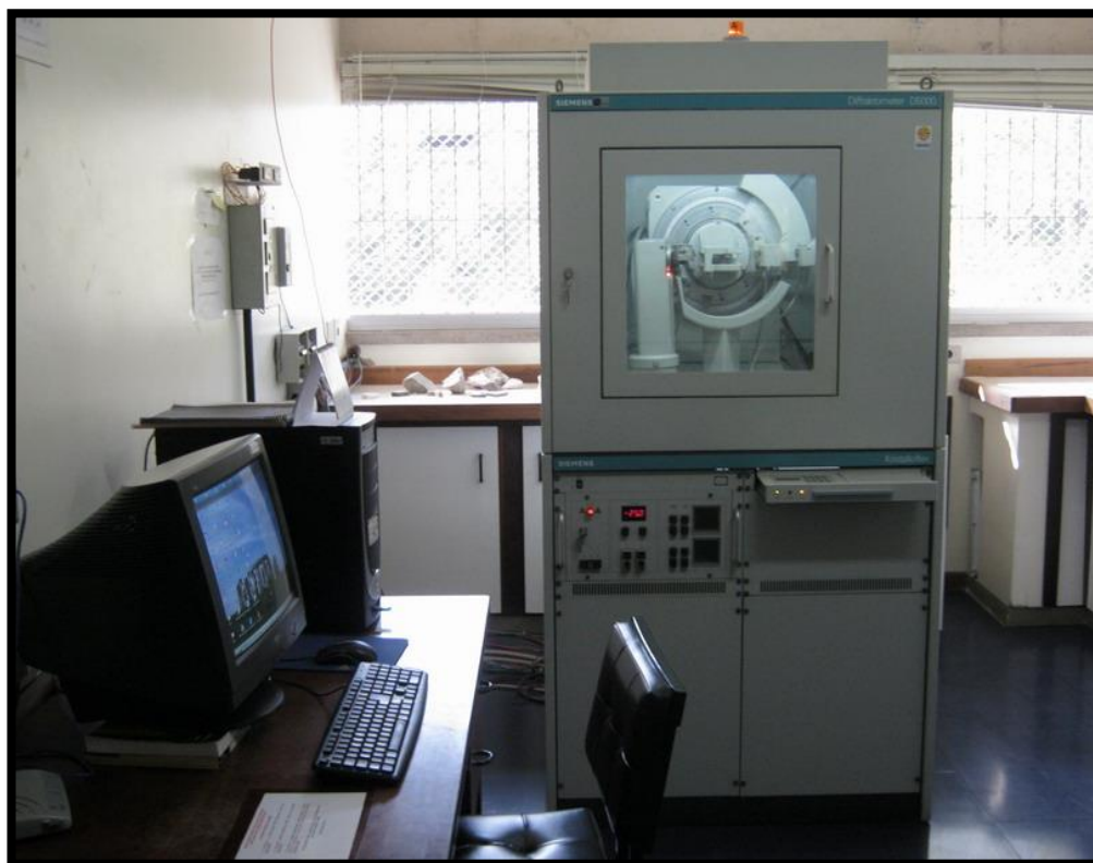
Figura 8 - Difratômetro de raios-X Siemens modelo D5000 (Laboratório de Difração de Raios-X - Instituto de Geociências).
