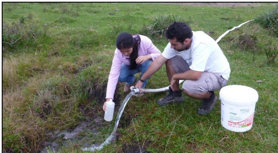
Figura 12 - Coleta de água, durante o ensaio de bombeamento, para análise físico-química.
