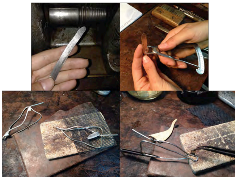
Figura 65: Laminação da chapa de prata e solda das cápsulas
