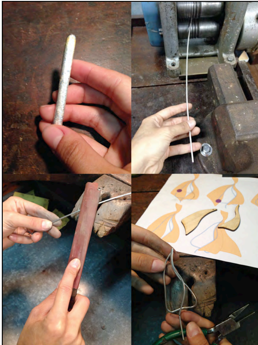
Figura 63: Lingote da liga, laminação e acabamento do fio e modelagem das estruturas dos brincos
