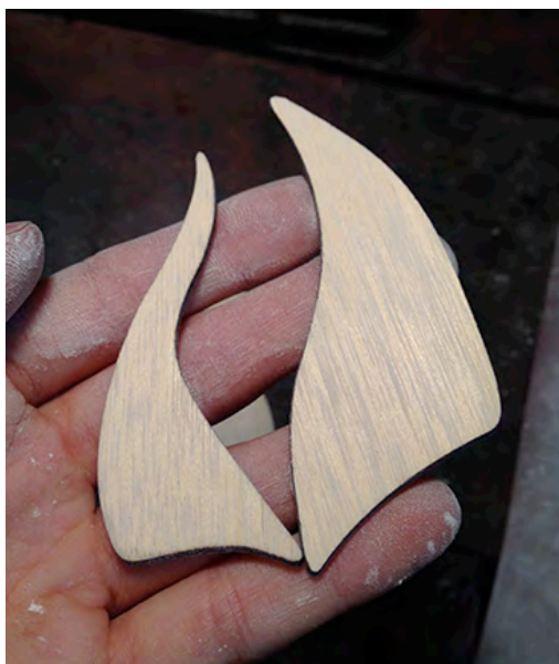
Figura 61: Textura da madeira balsa após lixada
