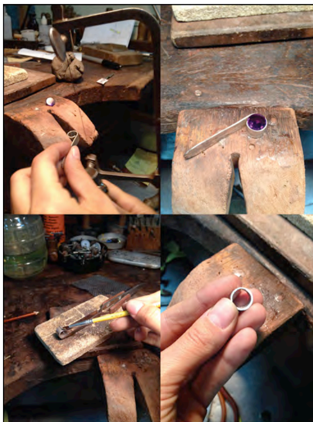
Figura 66: Confecção das caixas para cravação das ametistas
