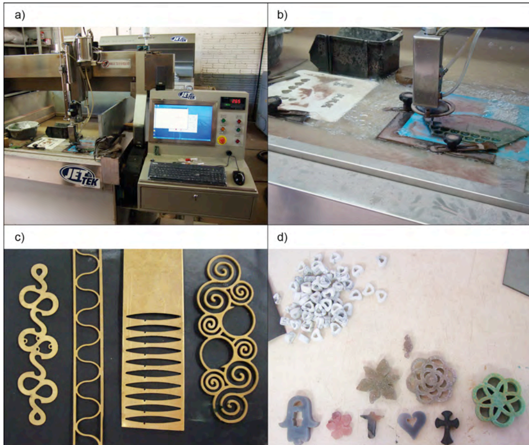
a) Equipamento de corte por jato d'água; b) Corte em chapa de ágata; c) Metal cortado pelo jato d'água; d) Peças de ágata cortadas por jato d'água
