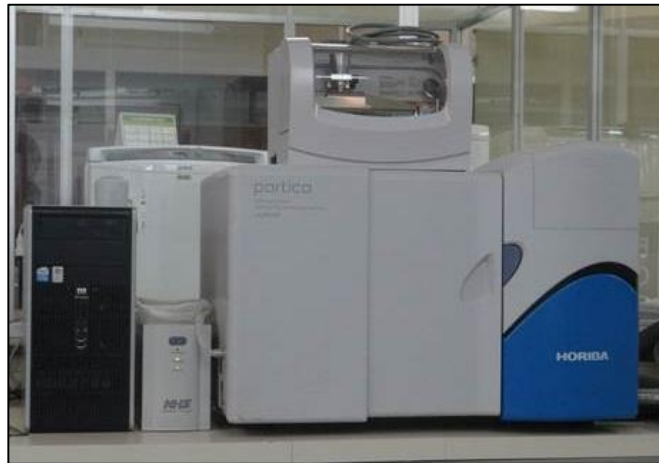
Figura 12 – Fotografia do equipamento utilizado para caracterização física dos biossólido, um analisador de tamanho de partícula por dispersão a laser, Horiba LA-950.
