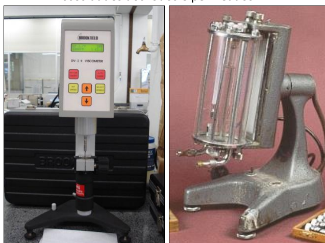
Figura 10 – Viscosímetros rotativo (esquerda) e de Hoeppler (direita), utilizados para as medições das viscosidades dos lodos e permeados.
