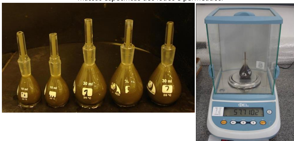
Figura 11 – Conjunto de picnômetros (esquerda) e balança analítica (direita), utilizados para a medição das massas específicas dos lodos e permeados.
