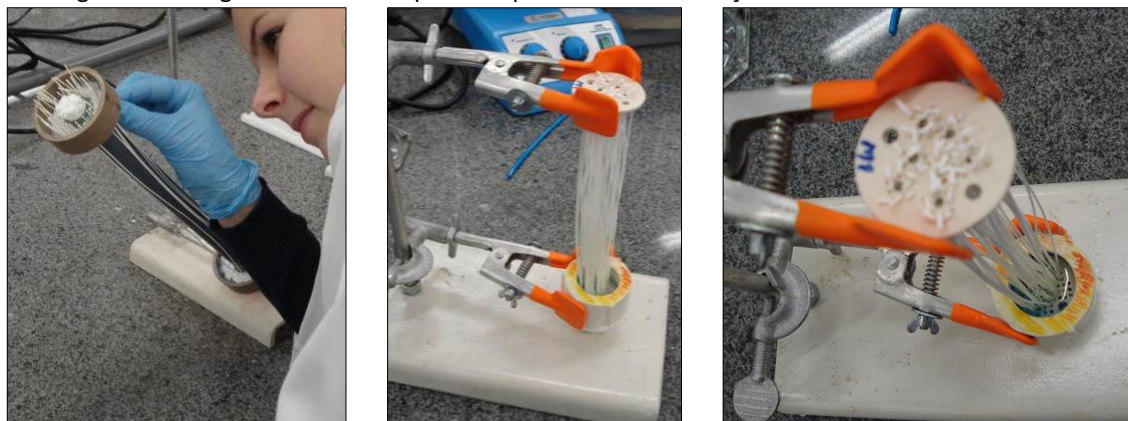
Figura 9 – Fotografias ilustrando parte do processo de construção dos módulos de membranas.
