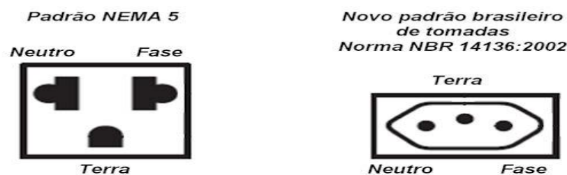
Figura 10 – Novo Padrão de Tomadas Elétricas Tremulares Monofásicas 3 (três) Pinos, Padrão NEMA 5P
