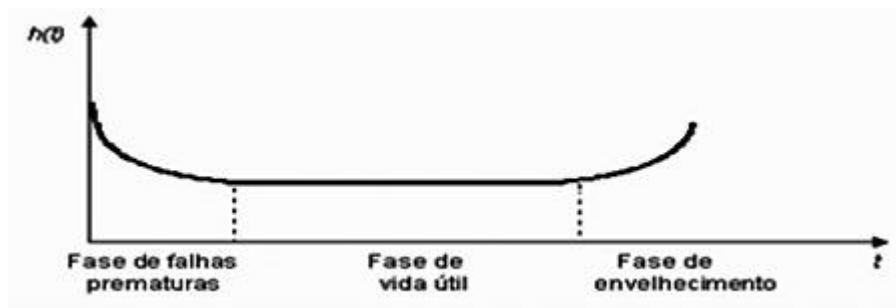
Figura 9 – “Curva da Banheira” típica de dispositivos eletrônicos.
