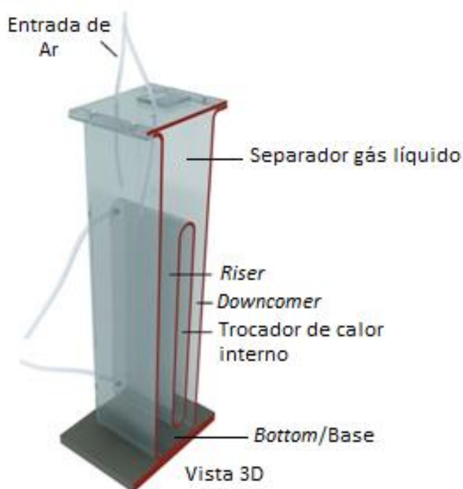
Figura 7: Representação dos fotobiorreatores utilizados no desenvolvimento deste trabalho.
