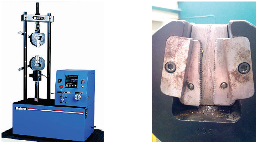
Figura 4.7 – À esquerda a máquina de ensaios de tração Speedy Tester LCH-20 e , à direita, detalhe o sistema de fixação por cunhas.
