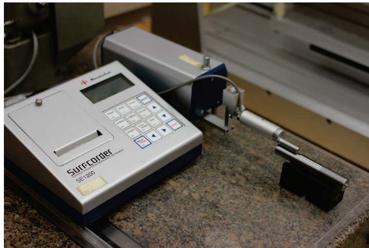
Figura 4.8 – Rugosímetro Surfcoorder SE1200 utilizado para verificação da rugosidade dos mandris.
