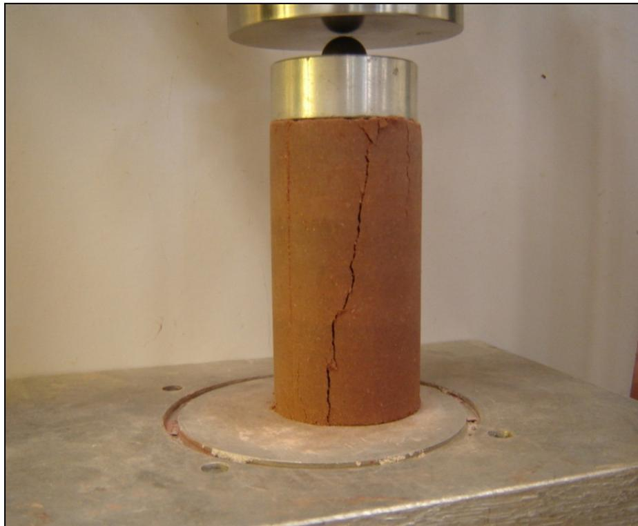
Figura 30: plano de ruptura típico dos corpos-de-prova
