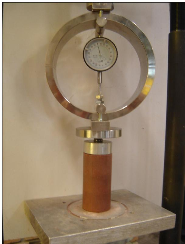
Figura 18: corpo-de-prova submetido ao ensaio de resistência à compressão simples
