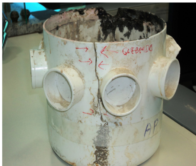
Figura 79 – Caixa coletora quebrada
