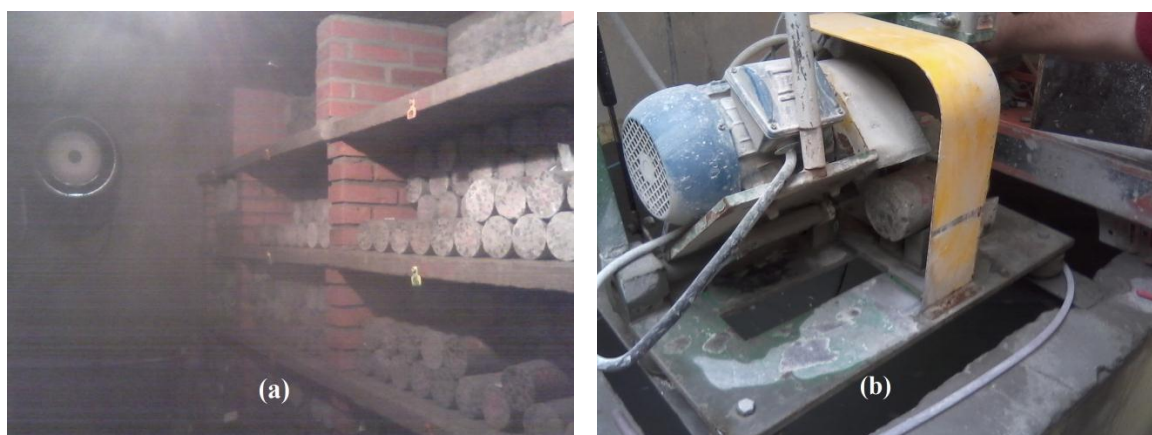
Figura 7 – (a) Vista geral dos CPs em processo de cura em câmara úmida e (b) CP posicionado para início do processo de retificação
