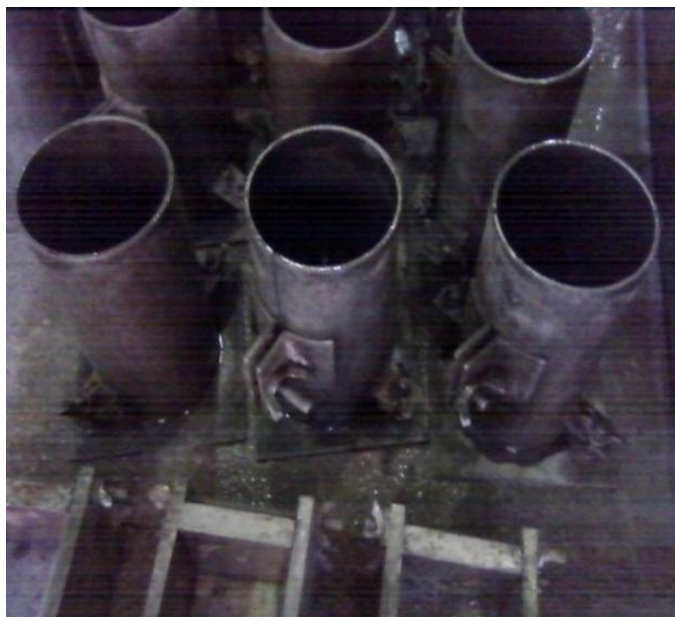
Figura 5 – Moldes metálicos utilizados no experimento
