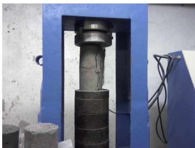
Figura 8 – Aspecto do CP após submetido a esforços de compressão
