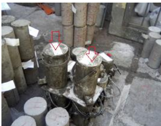
Figura 6 – Vista geral de CPs identificados ainda dentro dos moldes metálicos
