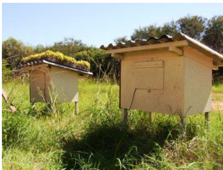
Figura 2 – Experimento para medição do desempenho térmico do telhado verde
