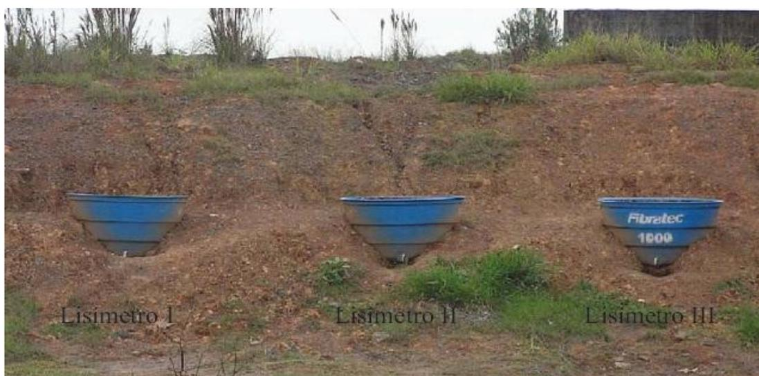
**Figura 8** - Ensaio em campo com rejeito de carvão e cobertura seca, com três lisímetros para coleta do lixiviado
