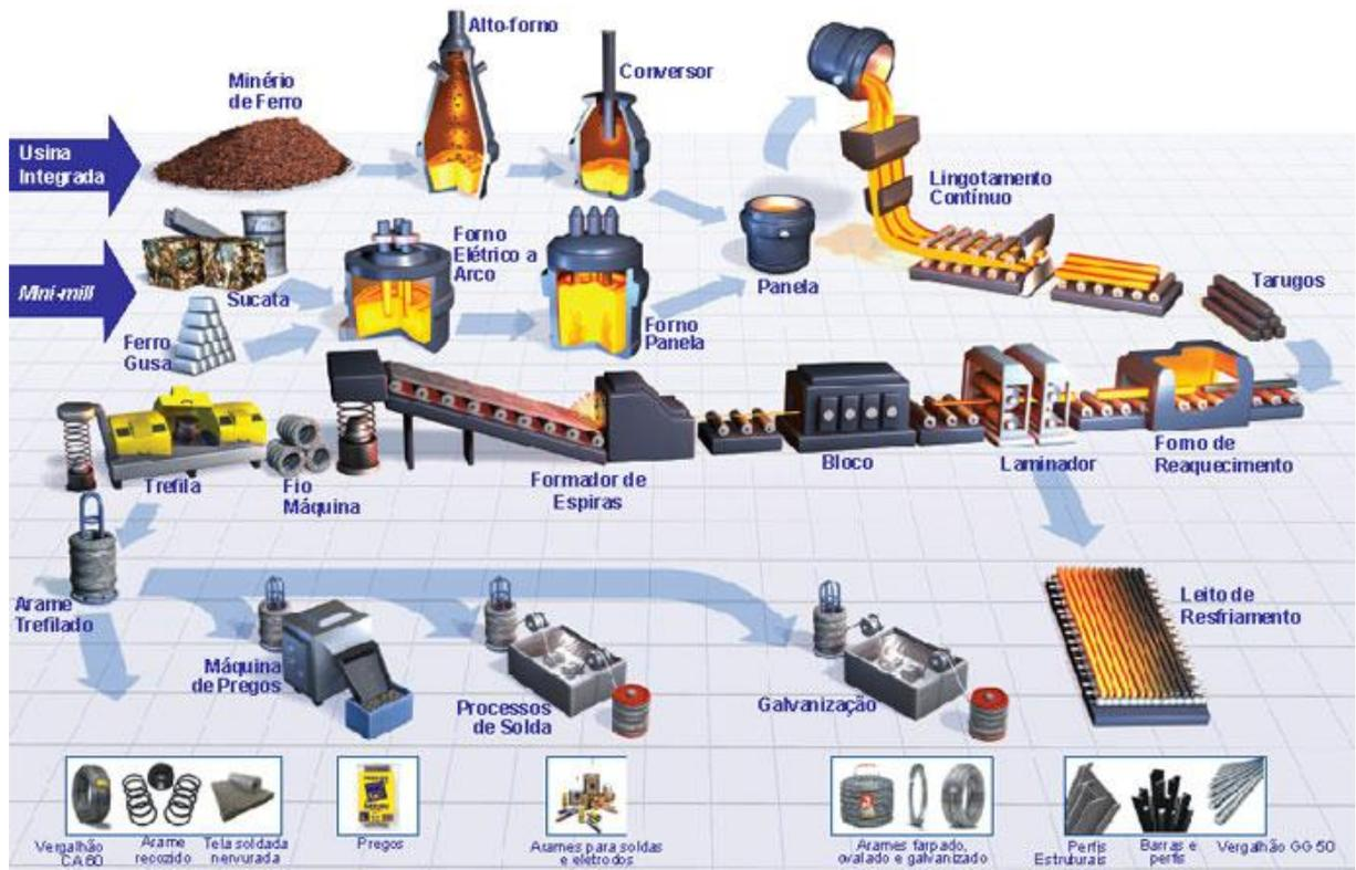
**Figura 9** - Esquema de produção do aço em usinas integradas e em usinas semi-integradas
