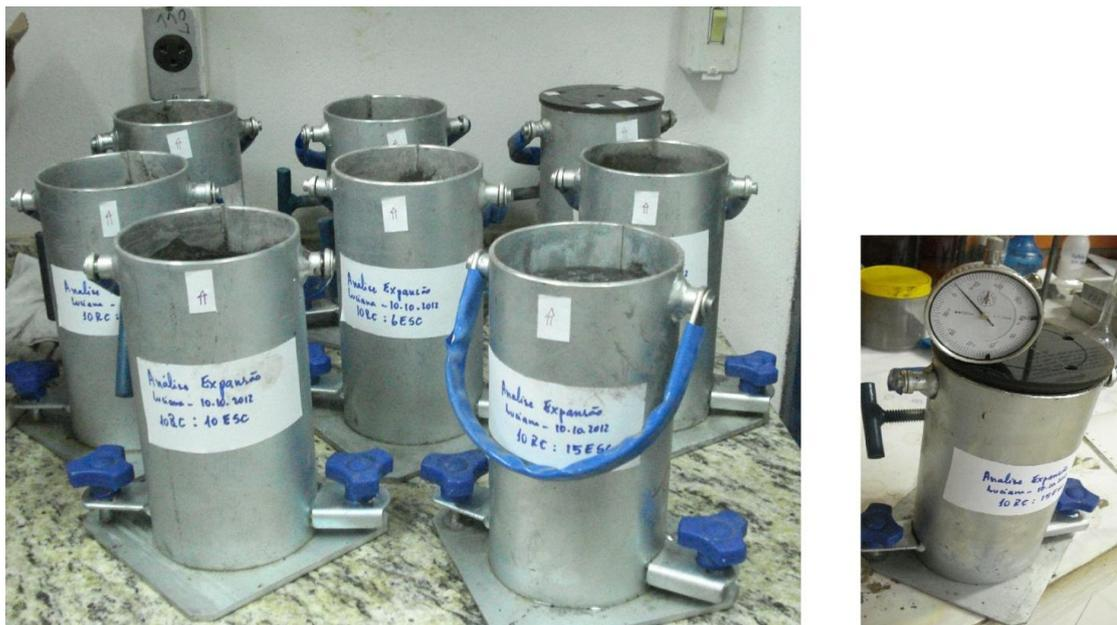
**Figura 12** - Ensaio de expansão em moldes cilíndricos com rejeito de carvão, escória de aciaria elétrica do forno panela e mistura entre os materiais nas seguintes proporções: RC:EAE-FP 10:2, RC:EAE-FP 10:4, RC:EAE-FP 10:6, RC:EAE-FP 10:8, RC:EAE-FP 10:10 e RC:EAE-FP 10:15
