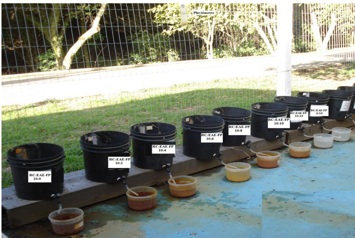
**Figura 14** - Experimento com rejeito de carvão, escória de aciaria elétrica do forno panela e misturas entre os materiais expostos às precipitações pluviométricas na planta experimental no LEAmet da UFRGS
