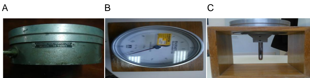
Figura 8. Dinamômetro com alça ajustável. A – vista lateral sem suporte. B – vista superior. C – vista lateral com suporte de madeira.
