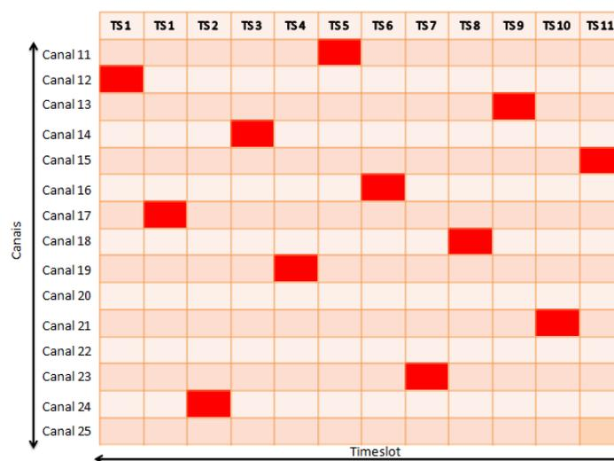
**Figura 10** Operacionalidade do *channel hopping* no protocolo *WirelessHART*.
