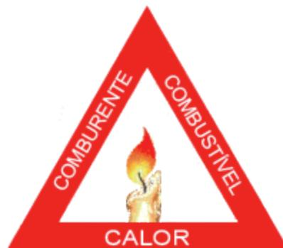
Figura 1.1 – Elementos do Triângulo do Fogo
