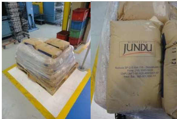
Figura 9: Areia Shell utilizada para fabricação dos machos.
