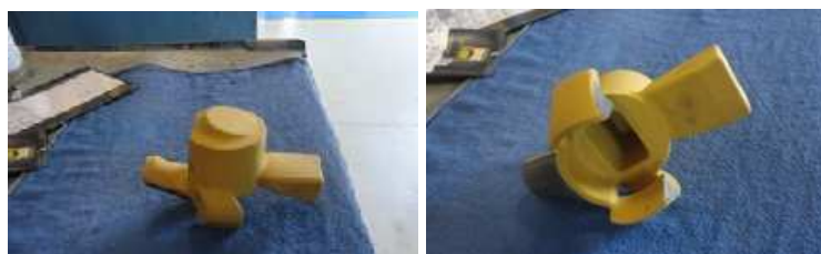
Figuras 4 e 5: Macho em areia com resina Shell. Fonte: Empresa estudada.
