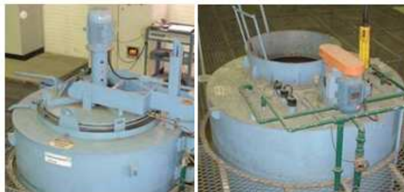
Figura 16: Forno de aquecimento. Figura 17: Tanque de resfriamento. Fonte: Empresa estudada.
