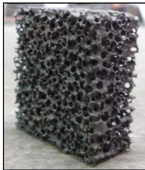
Figura 18: Filtro antes do vazamento. Figura 19: Filtro após vazamento.
