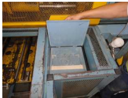
Figura 11: Compartimento de alimentação de areia na sopradora na empresa estudada. Fonte: Empresa estudada
