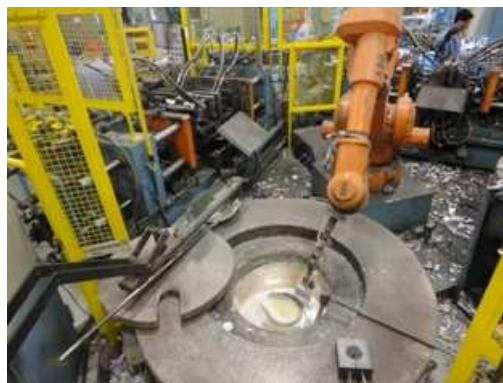
Figura 13: Coleta do metal para vazamento no molde.
