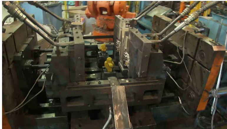
Figura 12: Macho em areia dentro da coquilha
