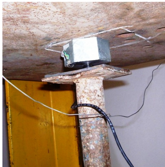
Figura 25: tampão hidráulico sextavado de ferro maleável preto, com a carga aplicada através de uma esfera no centro da peça
