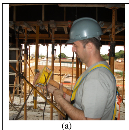
Figura 120: foto ilustrativa do posicionamento da célula de carga no pontalete
