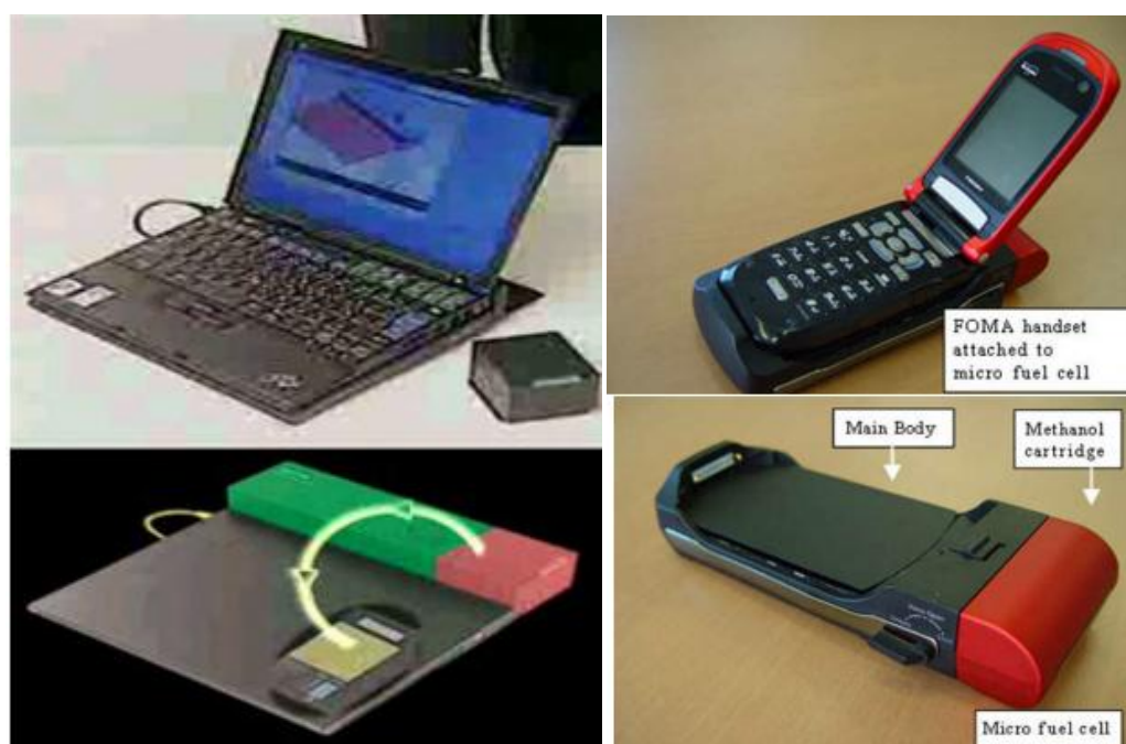
Figura 9. A Esquerda : Protótipo de DMFC adicionado a um computador portátil (Sanyo & IBM), A Direta : Carregador berço da DMFC para o aparelho FOMA (DoCoMo, Japan) (retirado de [34]).
