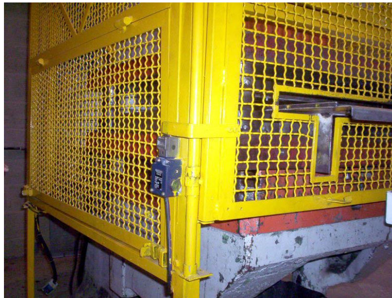
Figura 10 – Enclausuramento da zona de prensagem por proteções móveis intertravadas Fonte: Becker “et al.” (2006)
