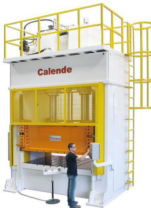
Figura 18 - Prensa de grande dimensão com plataforma, escada de acesso e guarda-corpo Fonte: Silva (2008)
