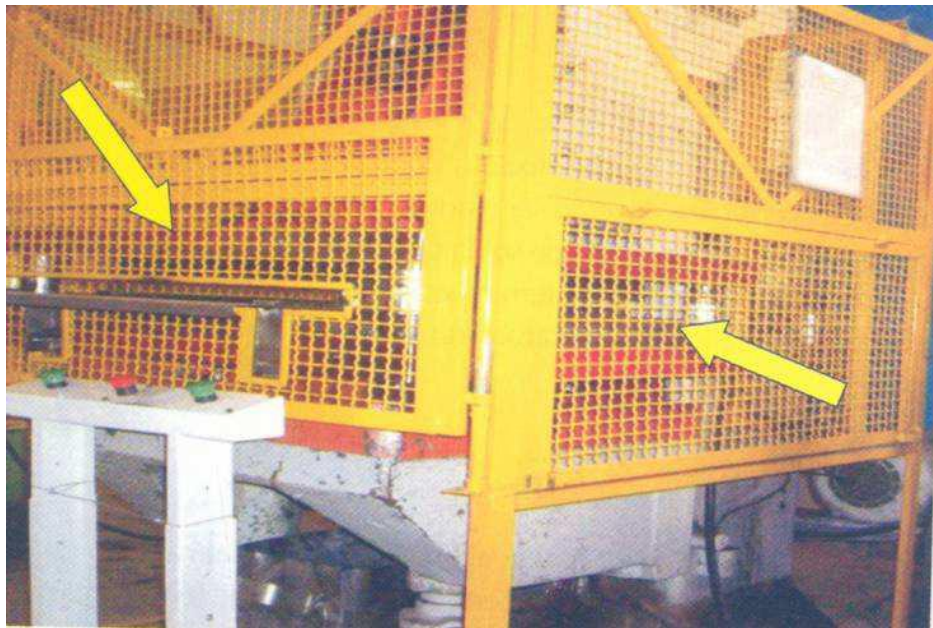
Figura 4 – Enclausuramento da zona de prensagem Fonte: Schunck (2006)
