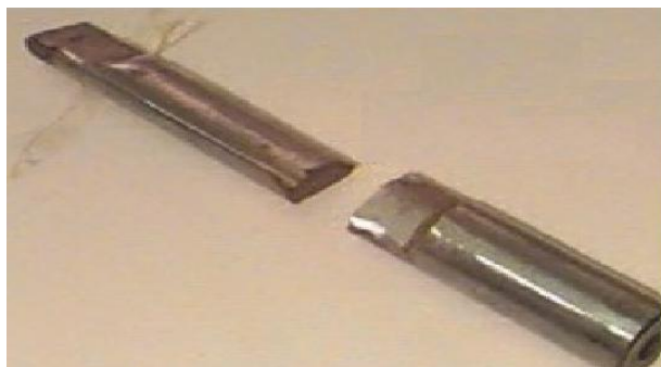
Figura 3 – Chaveta quebrada Fonte: Silva (2008)
