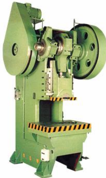
Figura 5 - Prensa mecânica excêntrica com freio/embreagem Fonte: Becker “et al.” (2006)
