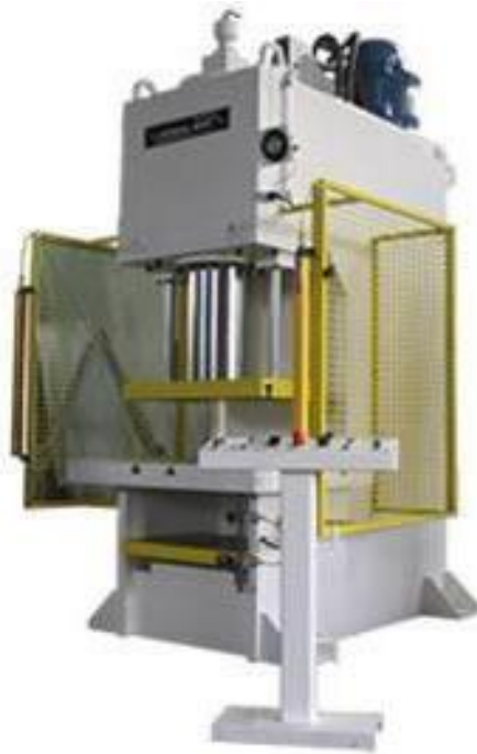
Figura 8 - Prensa hidráulica protegida Fonte: Silva (2008)
