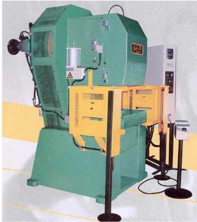
Figura 6 – Prensa mecânica excêntrica com freio/embreagem protegida Fonte: Silva (2008)
