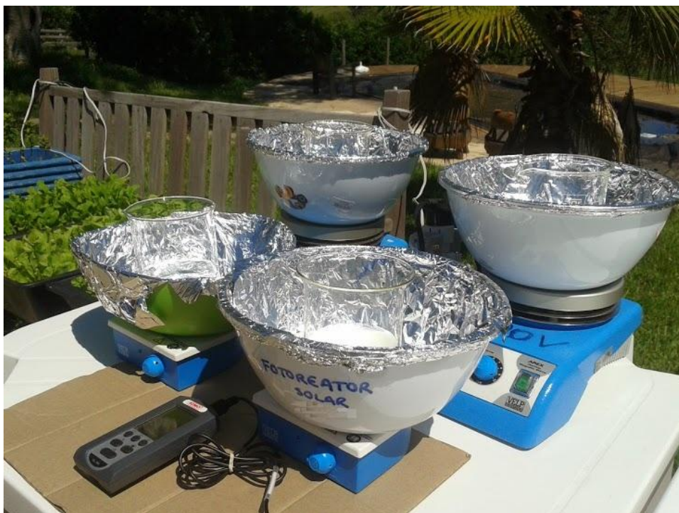
Figura 9. Experimento de fotocatalise sob luz solar.
