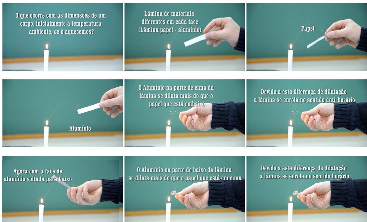
Figura 4.41: Capturas de tela do vídeo “Lâmina “bimetálica” (Vídeo 2)”.
