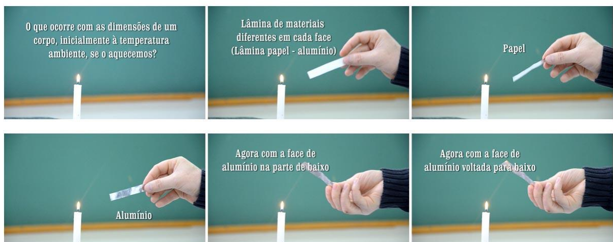
Figura 4.40: Capturas de tela do vídeo “Lâmina “bimetálica” (Vídeo 1)”.
