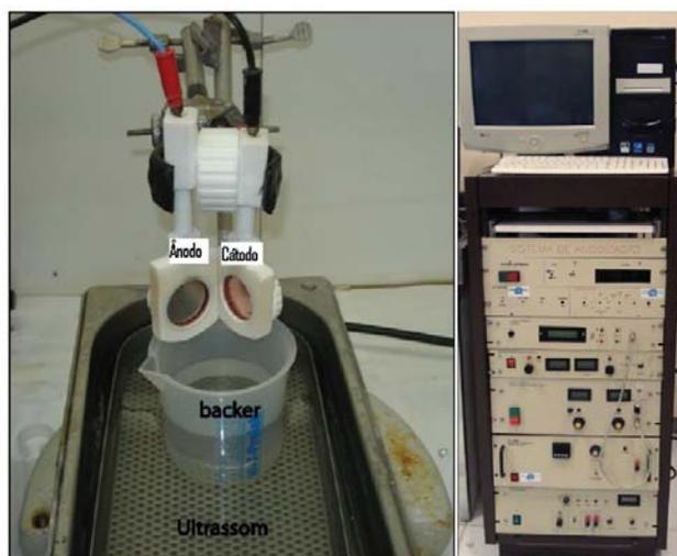
Figura 19: a) Fotografia do reator de anodização, b) sistema de fontes e aquisição utilizados durante os processos de anodização.<sup>21</sup>
