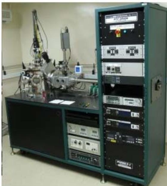
Figura 20: Foto do equipamento de *sputtering* utilizado para deposição de CdSe.<sup>71</sup>
