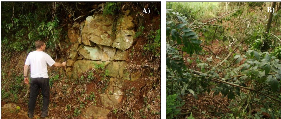
**Figura 37** - Afloramento em estrada vicinal em cota aproximada de 359 m no município de Três Coroas-RS. A) Afloramento de basalto da Fm. Serra Geral, rocha apresenta a infiltração de raízes nas fraturas. B) Cicatriz de movimento de blocos e de massa.
