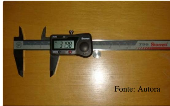
**Figura 5:** Paquímetro Eletrônico Digital Série 799 6/150 (Starret®)
