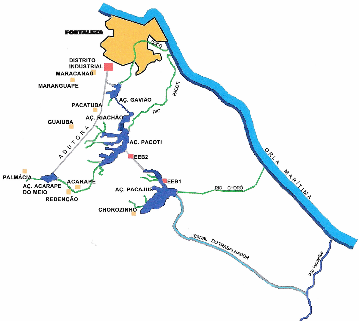
Figura 3.1a – Representação Esquemática do Sistema Integrado de Abastecimento da Região Metropolitana de Fortaleza (RMF)
